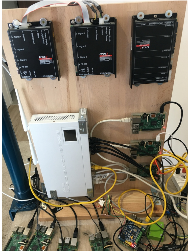
Rys. 6.11. Układ sterowania napędami złącz prototypu egzoskieletu.
