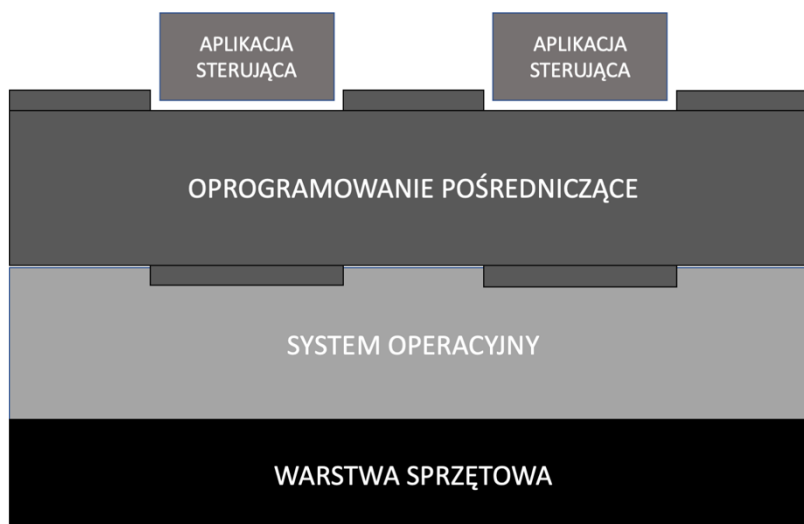
Rys. 1.1. Umiejscowienie oprogramowania pośredniczącego w architekturze oprogramowania sterującego.
