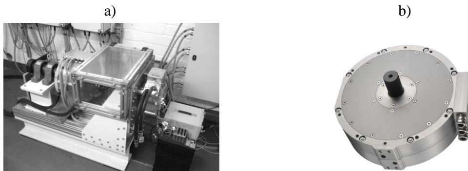
Rys. 1. Stanowisko pomiarowe do badań silników ze strumieniem osiowym (a) oraz silnik synchroniczny z magnesami trwałymi ze strumieniem osiowym o mocy 59kW (b)
