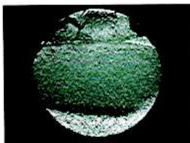
Rys. 4. Przełom zmęczenia próbki wykonanej ze stali a) P91 w warunkach zginania, b) 16Mo3 w warunkach kombinacji zginania ze skręcaniem
