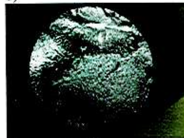
Rys. 4. Przełom zmęczenia próbki wykonanej ze stali a) P91 w warunkach zginania, b) 16Mo3 w warunkach kombinacji zginania ze skręcaniem
