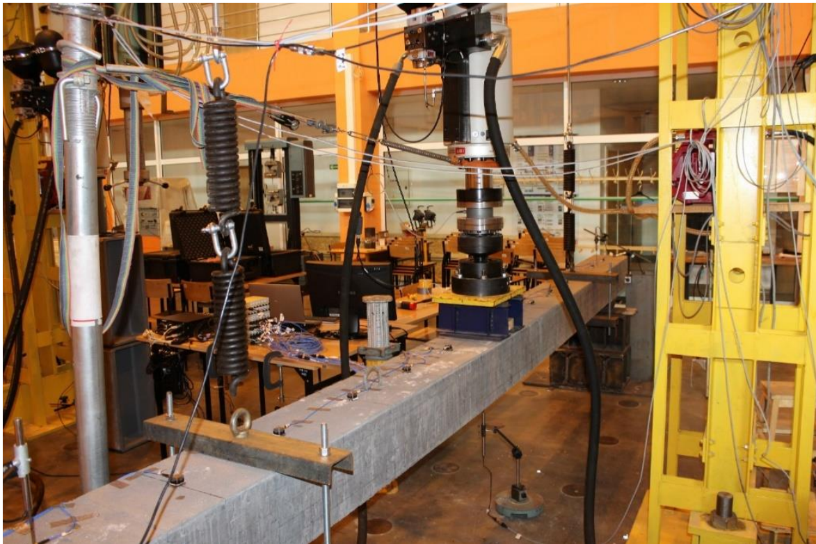
Rys. 1. Widok badanego elementu podczas badań eksperymentalnych na wykorzystaniem czujników prędkości rotacji do rekonstrukcji sztywności uszkodzonych belek żelbetowych [A]
